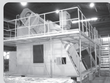
水処理場向／沈砂掻揚機
