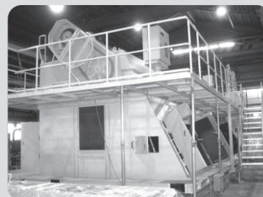
水処理場向／沈砂掻揚機
