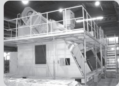
水処理場向/沈砂撈揚機
